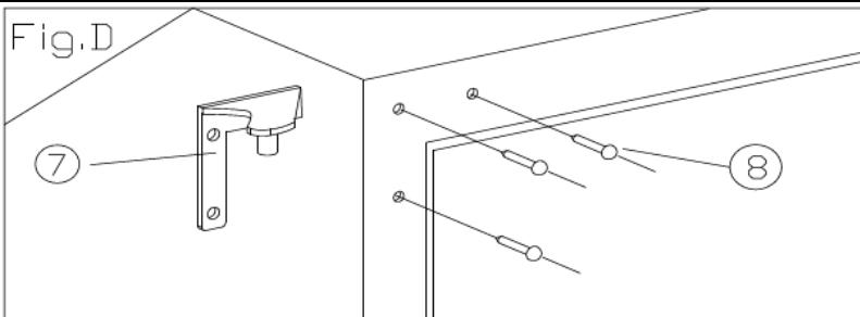
4. Entfernen Sie die Ziernägel (8) von der oberen linken Seite des Geräts und installieren Sie das obere Ersatzscharnier (links) (7) auf der oberen linken Seite mit drei Schrauben. (Abb. D)
