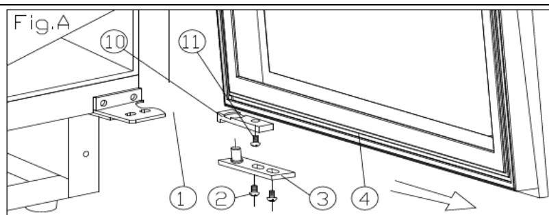
1. Öffnen Sie die Tür um 90 Grad. Die beiden Schrauben (2) der unteren Türachse lösen, die Tür (4) und die Türachse entfernen. (Abb. A)
