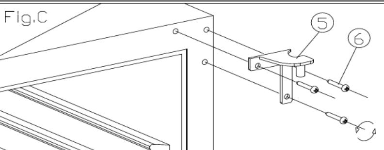
3. Retire los tres tornillos (6) de la bisagra superior (derecha) (5) y extrágala (fig. C).
