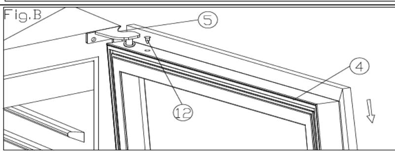
2. Positionieren Sie die Tür (4) ordnungsgemäß und entfernen Sie die Kappe (12) des oberen Teils des Türrahmens; lösen Sie eine der unteren Schrauben (11) und entfernen Sie die Haltevorrichtung (10). Installieren Sie diese Vorrichtung dann auf der Oberseite des Türrahmens. Es empfiehlt sich, eine Ersatzkappe (12) zum Abdichten der Öffnung an der Oberseite des Rahmens zu verwenden. (Abb. A/B)
