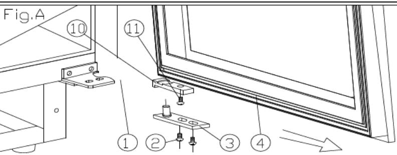
1. Abra la puerta 90 grados. Desatornille dos tornillos (2) del eje inferior de la puerta y, a continuación, retire la puerta (4) y el eje de la puerta (fig. A).
