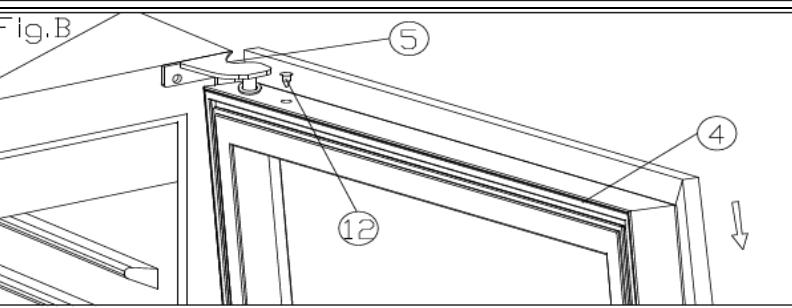
2. Coloque correctamente la puerta (4) y retire la tapa (12) de la parte superior del marco de la puerta; desatornille uno de los tornillos (11) inferiores y extraiga el dispositivo de retención (10). A continuación, instale el dispositivo en la parte superior del marco de la puerta. Es recomendable utilizar una tapa de recambio (12) para tapar el agujero de la parte superior del marco (fig. A/B).
