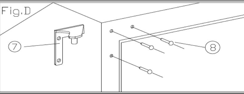
4. Retire los clavos embellecedores (8) del lado superior izquierdo del aparato e instale la bisagra superior de recambio (derecha) (7) en el lado superior izquierdo con tres tornillos (fig. D).
