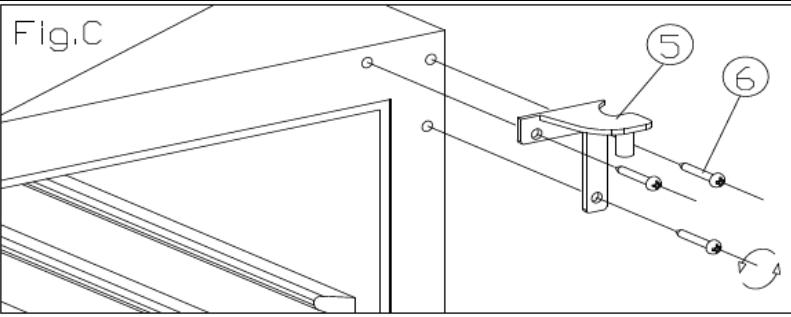
3. Entfernen Sie 3 Schrauben (6) vom oberen Scharnier (rechts) (5) und nehmen Sie dieses ab. (Abb. C)
