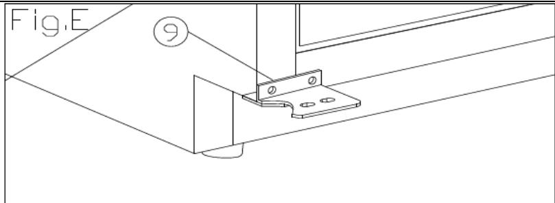
5. Siguiendo de nuevo el procedimiento anteriormente indicado, proceda a instalar la bisagra inferior de recambio (izquierda) (9) (fig. E).
