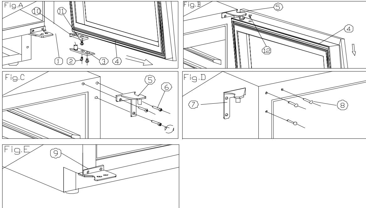
1. Open de deur 90 graden, haal 2 schroeven (2) uit de onderste deuras (3), verwijder de deur (4) en trek de deur- en deuras (fig. A) eruit.
